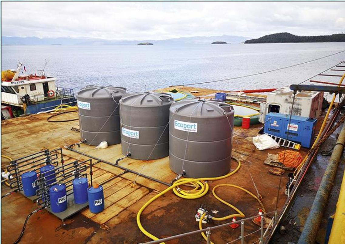
Proceso implementado por Ecoport permite clarificar y descargar al mar aguas contaminadas con hidrocarburos.
